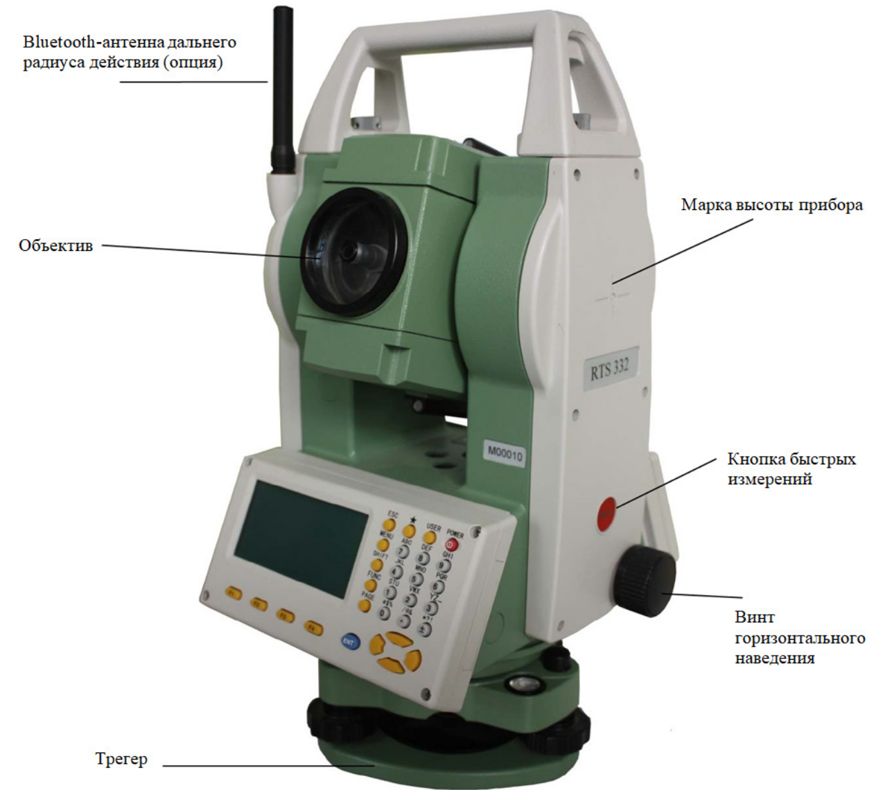
Рисунок 4 - Основные элементы тахеометров FOIF в модификациях RTS332N и RTS342N (передняя панель)
